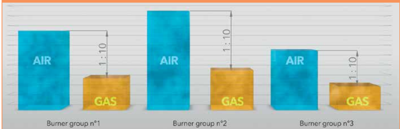
نسبت هوا - گاز در کوره‌های هوای مازوله
